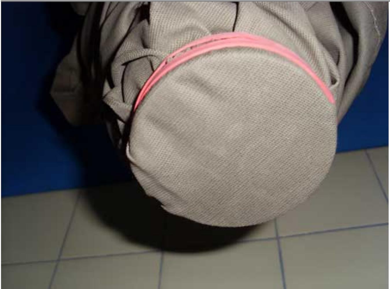
Unser Versuchsaufbau ist einfach. Eine Röhre über der Badewanne wird mit dem Stoff der mitgelieferten Abdeckplane verschlossen. Oben haben wir vor, nach und nach mehr Wasser einzufüllen, unten dann den ersten Tropfen photographieren. Es ist 19:41 Uhr und noch sind Röhre und Stoff trocken. Wir haben noch kein Wasser eingefüllt.
