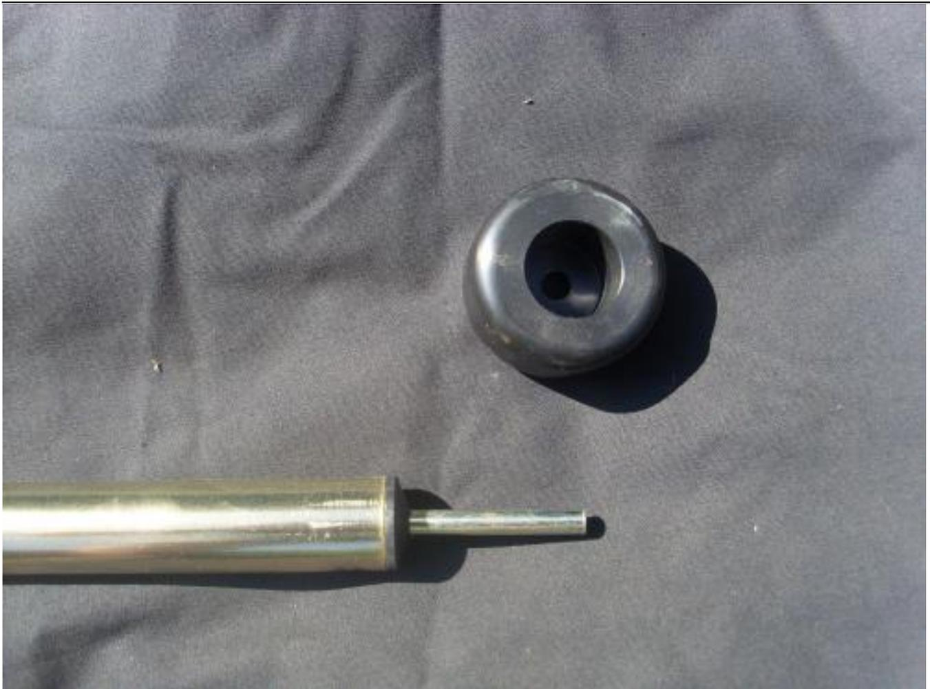
Optional kannst du nun noch eine [Schutzkappe](#) [219] aufsetzen. Diese hat den Vorteil, dass dein Jurtendach, bzw. die Ösen darin höhere Kräfte aufnehmen können. Das ist vor allem bei stürmischem Wetter sinnvoll.
