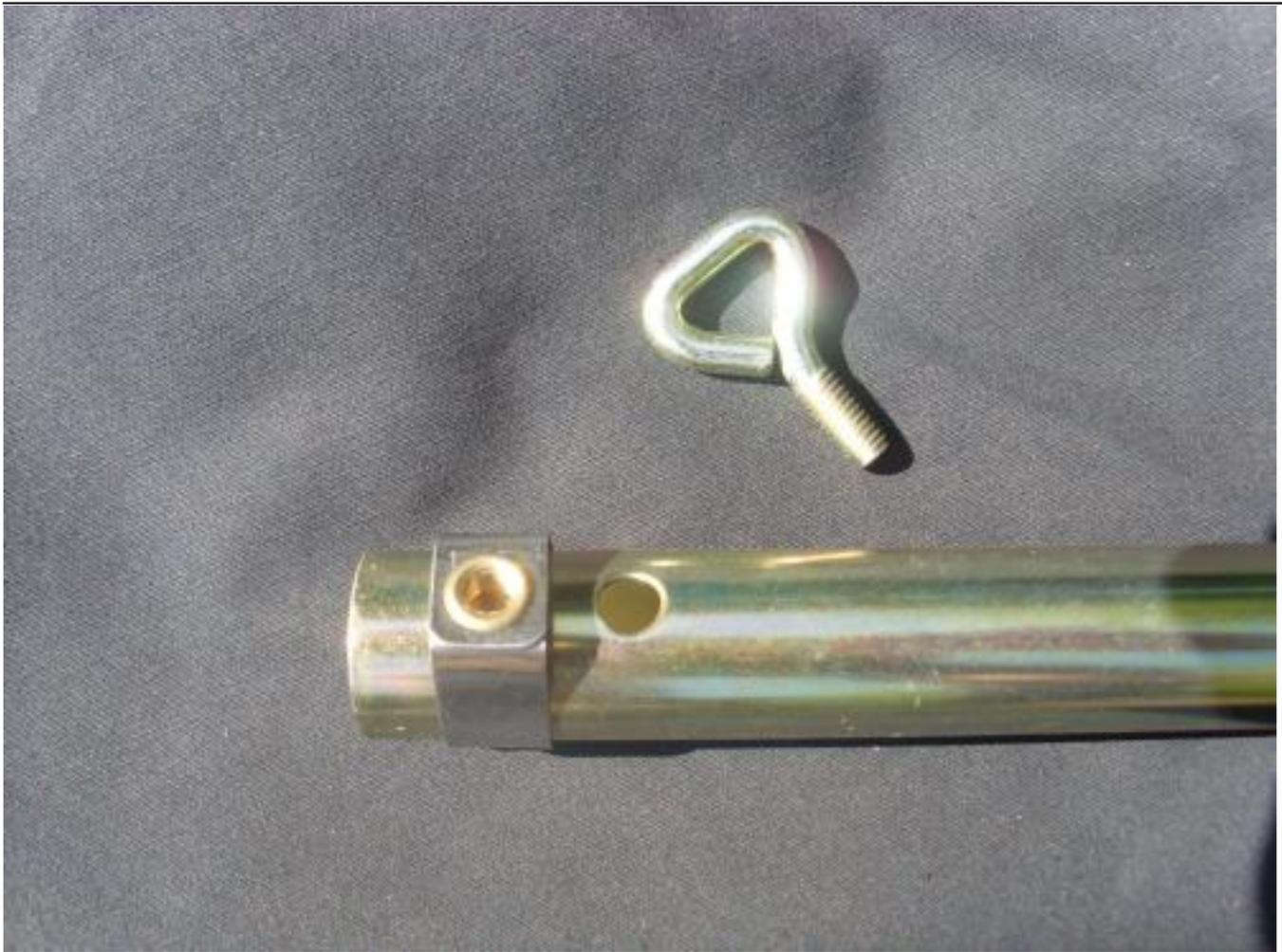
Die Rohrschelle wird auf das dickere Stangenende mit Loch aufgeschoben. In der Rohrschelle ist das Gewinde für die Herzschraube, mit der du die Teleskopstange in einer beliebigen Höhe fixieren kannst. Früher war dieses Gewinde direkt in das Rohr eingepresst. War dies einmal kaputt, so konnte es nicht wieder repariert werden. Heute musst du einfach die Rohrschelle auswechseln.
