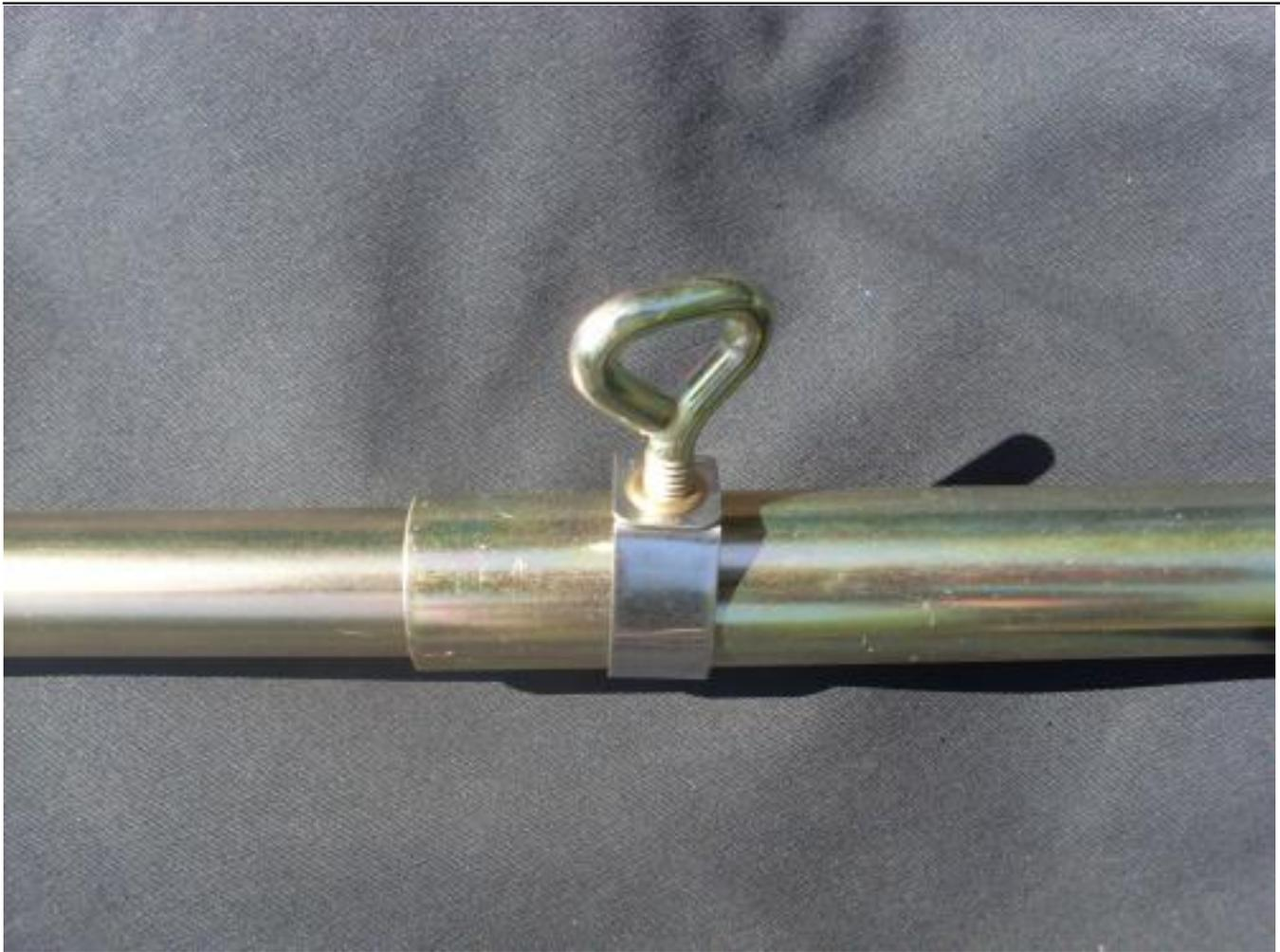
Jetzt kannst du das dünnere Rohr einschieben und an jeder beliebigen Stelle mit der Rohrschelle und der Herzschaube festziehen. Üblicherweise können die Stangen zwischen 160 cm und 250 cm variiert werden.
