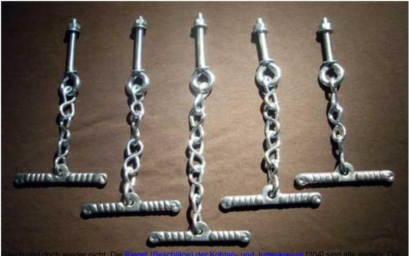
Gleich und doch wieder nicht. Die [Riegel \(Beschläge\) der Kohten- und Jurtenkreuze](#) [204] sind alle anders. Die Funktion jedoch ist immer die gleiche. Die Schrauben oben im Bild sind fest mit dem Kohtenkreuz verschraubt.
